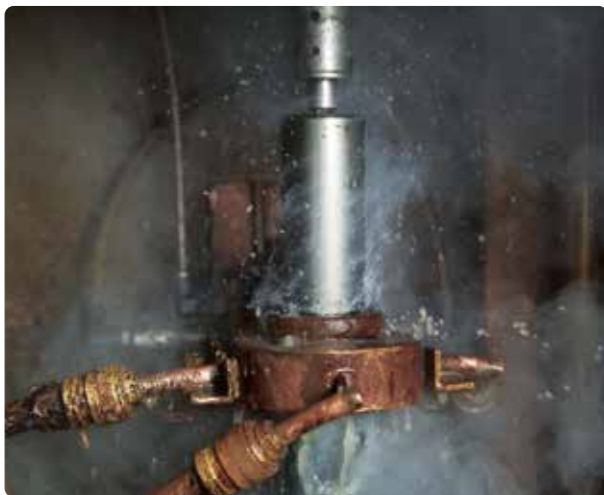
La durabilidad superior proviene del endurecimiento por inducción del eje del cilindro.
