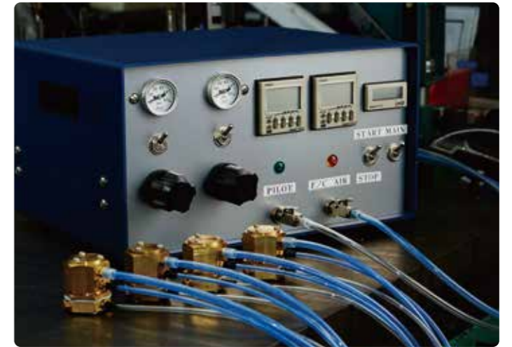
Todas las válvulas se someten a 1 millón de repeticiones de pruebas de durabilidad.
